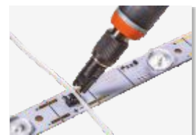
Leitung wird mit einem Spezialwerkzeug in eine Schneidklemme gedrückt.
