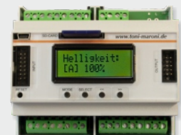
SCARLETT für Hutschienenmontage als fest installierte Steuerung
