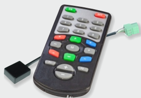
IR-Fernbedienung zur Einstellung vorprogrammierter RGB-Rainbow Verläufe
