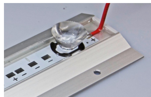
LED, Optik und Platine hermetisch dicht vergossen
